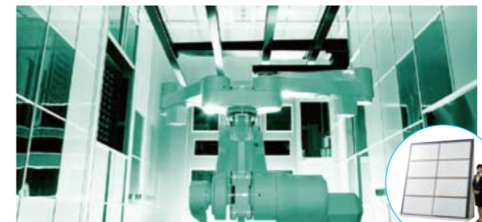
薄さ0.7mmの大型マザーガラスをロボットが搬送する液晶工場
